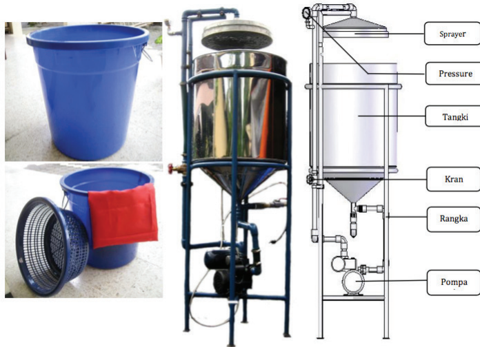
Gambar 2.25 Peralatan yang digunakan dalam proses perendaman, aerasi, dan pengendap
