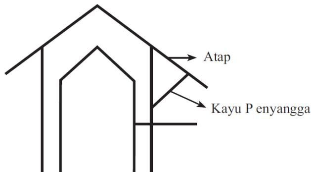
Gambar 2. Tampak Samping Tiang Penyangga Atap Bangunan
