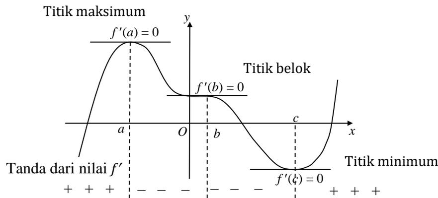
Gambar 2. Titik Maksimum, Titik Minimum, dan Titik Belok
