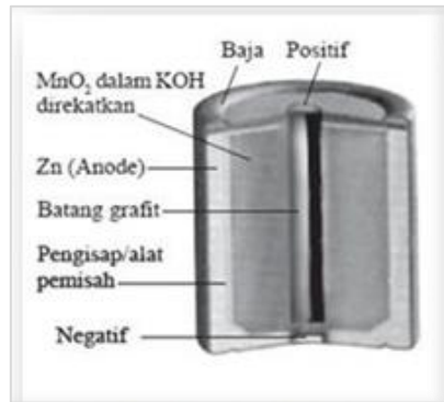
Gambar 6. Skema baterai alkaline
