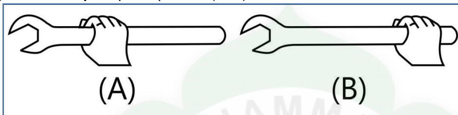
Gambar 1. (A) Kunci Inggris yang Diputar oleh Tangan yang Dekat dengan Poros Putar (B) Kunci Inggris yang Diputar oleh Tangan yang Jauh dari Poros Putar
